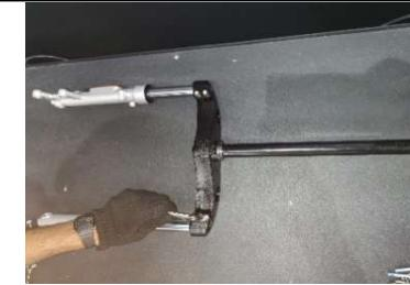
**Passo 3: Inserir o garfo no local indicado do quadro (Atentar-se ao rolamento que deve ser inserido na parte inferior "as esferas devem ficar voltadas para cima"; Será necessário cavalete ou algum tipo de suporte, para manter a motoneta em pé.**
