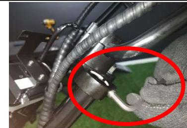
**Passo 11:** Instalação de arruela e do acabamento cromado, na parte superior central do garfo; (Utilizar chave de boca 32 ou chave inglesa).
