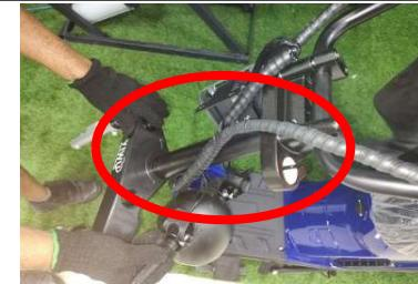
**Passo 5: Posicionar o conjunto de rolamento e fixação do garfo na parte central, respeitando sua sequência, conforme imagem ao lado.**
