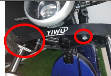
**Passo 10:** Fixação na parte superior das barras de reforço (Utilizar a chava alien Nº 8).
