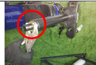
**Passo 7: Posicionamento e instalação das barras de reforço do garfo.**
