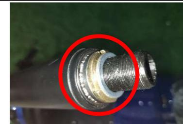
**Passo 6: Aplicar torque final no conjunto de rolamento do garfo na parte central, (Utilizar o alicate de pressão).**
