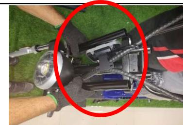
**Passo 8:** Após a instalação das barras de reforço, utilizar a marreta de borracha com cautela para encaixá-los adequadamente na parte superior **Obs.: se as barras não estiverem encaixando no local, deverá ser utilizada uma chave de fenda para alargar um pouco o local de encaixe "Com cautela, para não quebrar a peça".**
