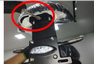
**Passo 24: Instalar placa de identificação traseira (Utilizar chave alien Nº 5).**
