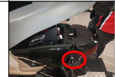
Passo 3: Remover os quatro parafusos de fixação da parte plástica abaixo do banco (Utilizar chave PHILIPS e chave canhão Nº 10).
