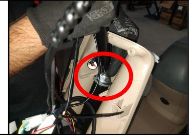
**Passo 18:** Remover parafusos laterais da mesa para posicionar o guidon, (utilizar chave PHILIPS).
