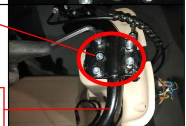
**Passo 20:** Posicionar o guidon e apertar os parafusos da mesa, (utilizar chave alien Nº 6), Obs.: Após ajuste do guidon, verificar se há necessidade de alinhar as manetes de freio, caso haja necessidade de ajuste, utilizar chave allen Nº 5.
