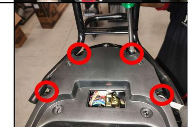
Passo 5: Instalar o acabamento Nº 1 "CINZA" do encosto traseiro, (utilizar chave PHILIPS).
