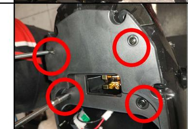
Passo 4: Instalar a ferragem do encosto traseiro (Utilizar chave de boca Nº 10 e chave canhão Nº 10); Obs.: Essa ferragem não é fixada pelos parafusos removidos no passo 3 e sim por 4 parafusos independentes (Comp. 18mm X Ø 6mm).
