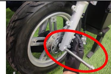
**Passo 18: Instalar o espaçador maior do lado direito e terminar de instalar o eixo.**
