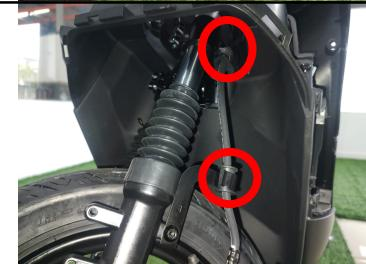
**Passo 22: Instalar paralama dianteiro utilizando a chave alien Nº 5.**
