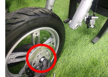
**Passo 17: Inserir o eixo da roda dianteira pelo lado esquerdo.**
