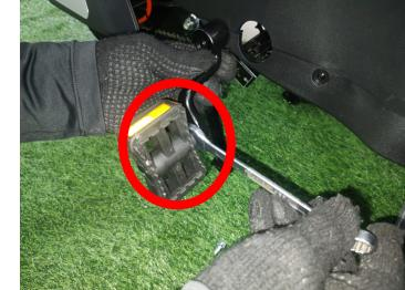
**Passo 25: Instalar os dois pés de vela "já com os pedais" em posições invertidas no quadro da motoneta, utilizando chave de boca Nº 12.**
