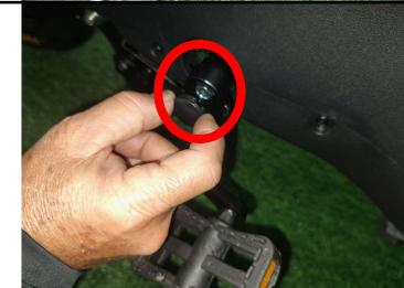
**Passo 27: Remover proteção e instalar os retrovisores utilizando uma chave de fenda e uma chave de boca Nº 14.**
