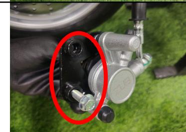
**Passo 19: Afastar as pastilhas de freio, utilizando uma chave de fenda; Obs.: Executar essa tarefa com cautela para não danificar as pastilhas.**
