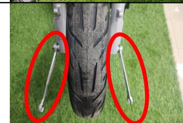
**Passo 18: Remover dois parafusos da pinça de freio para poder instalar o sistema de frenagem, utilizando uma chave de boca Nº 10.**
