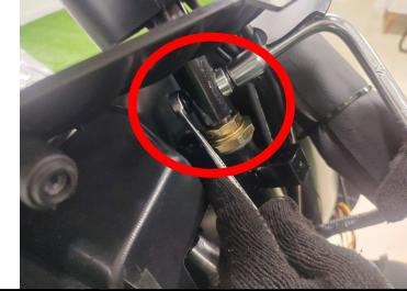
**Passo 14: Reinstalar a peça de suportação dos cabos elétricos e fixação da carenagem que foi removida no passo 9, utilizando uma chave philips e chave de boca Nº 10.**
