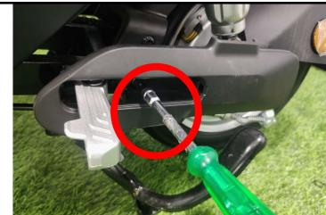
Passo 4: Instalar o descanso central, utilizando uma chave canhão Nº 12.
