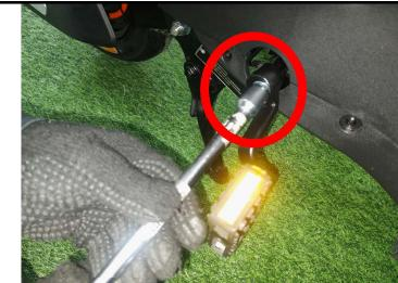
**Passo 26: Após o aperto final no pé de vela, deverá ser instalado o acabamento de plástico.**
