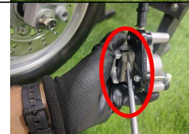
**Passo 20: Posicionar o sistema de frenagem, reinstalando os parafusos que foram removidos no passo 18, utilizando a chave de boca Nº 10.**
