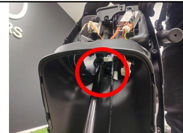
Passo 9: Remover peça de suportação dos cabos elétricos e fixação da carenagem utilizando uma chave philips e chave de boca Nº 10.
