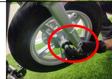
**Passo 19: Aplicar aperto final no eixo da roda dianteira, utilizando chaves de boca Nº 14 e Nº 17.**
