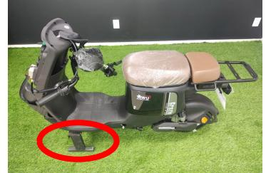
Passo 3: Remover carenagem lateral para instalação do descanso central, utilizando chave canhão Nº 10.
