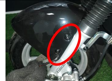
**Passo 23: Remover parafusos dos pedais que encontram-se fixados no quadro da motoneta, utilizando chave canhão Nº 12.**
