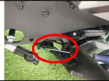
Passo 6: Reinstalar a carenagem lateral que foi removida no passo 3, utilizando chave canhão Nº 10.
