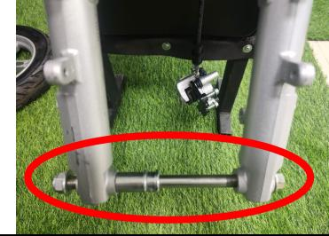
**Passo 16: Posicionar a roda dianteira e instalar o espaçador menor do lado esquerdo; Obs.: lado esquerdo é o lado do sistema de frenagem.**
