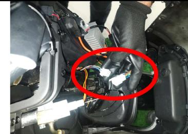
**Passo 29: Ligar cabo da bateria e disjuntor, para realização de testes elétricos.**
