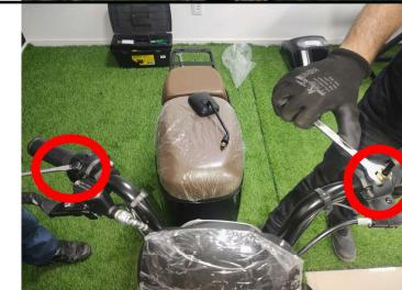
**Passo 28: Realizar a conexão do cabo elétrico da carenagem frontal e posicioná-la.**
