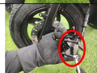
**Passo 19: Afastar as pastilhas de freio, utilizando uma chave de fenda; Obs.: Executar essa tarefa com cautela para não danificar as pastilhas.**
