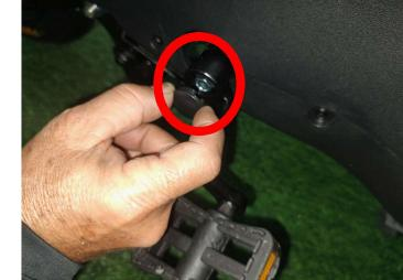
**Passo 29: Remover proteção e instalar os retrovisores utilizando uma chave de fenda e uma chave de boca Nº 14.**
