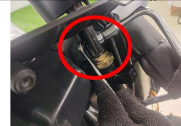
**Passo 12: Reinstalar peça que foi removida no passo 9 utilizando uma chave philips.**
