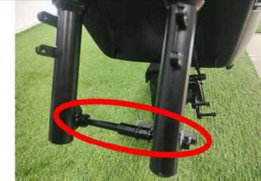
**Passo 14: Posicionar a roda dianteira e instalar o espaçador menor do lado esquerdo; Obs.: lado esquerdo é o lado do sistema de frenagem.**
