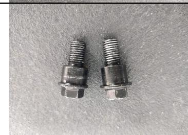
Parafusos tipo máquina para fixação do paralama (Comp. 12mm X Ø 5mm).
