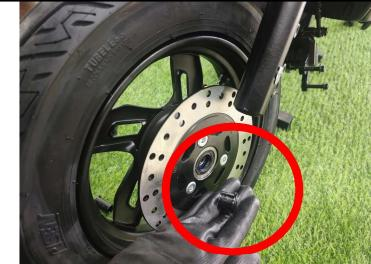
**Passo 15: Inserir o eixo da roda dianteira pelo lado esquerdo.**
