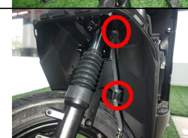
**Passo 22: Instalar paralama dianteiro utilizando a chave alien Nº 5.**
