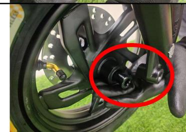
**Passo 17: Aplicar aperto final no eixo da roda dianteira, utilizando chaves de boca Nº 14 e Nº 17.**
