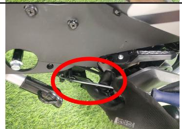
Passo 5: Remover peça de suportação dos cabos elétricos e fixação da carenagem utilizando uma chave philips.
