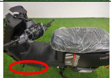
Passo 3: Instalar o descanso central para melhor equíbrio da motoneta, utilizando uma chave canhão Nº 12).
