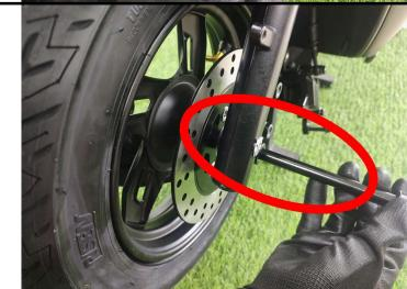
**Passo 16: Instalar o espaçador maior do lado direito e terminar de instalar o eixo.**
