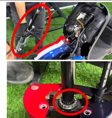
**Passo 6: Fixação do paralama dianteiro (Utilizar chave philips e chave de boca Nº 10).**
