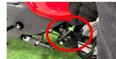
**Passo 17: Remover os parafusos de fixação das pedaleiras que estão fixados ao quadro, posicionar as mesmas e reinstalar os parafusos, ao término da instalação, as carenagens que foram removidas no passo 14, deverão ser reinstaladas (Utilizar chave de boca Nº 10).**
