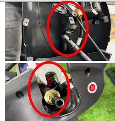
**Passo 8: Conectar o guidon no garfo e instalar o conjunto de parafuso de fixação (Utilizar chave de boca Nº 14 e chave canhão Nº 12).**
