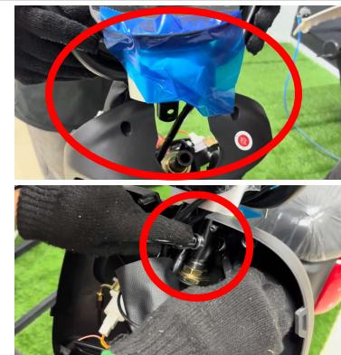
**Passo 9: Reinstalar o acabamento da carenagem do guidon, que foi removido no passo 4 (Utilizar chave philips).**
