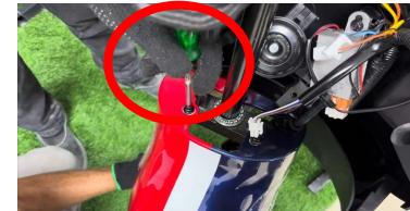
**Passo 7: Posicionamento do garfo e reinstalação das porcas, arruelas e rolamentos que haviam sido removidos anteriormente no passo 5 (Utilizar chave de boca Nº 32 ou chave inglesa e alicate de pressão).**
