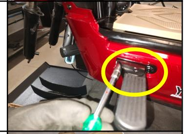
**Passo 9: Instalação da carenagem frontal interna, (utilizar chave PHILIPS).**
