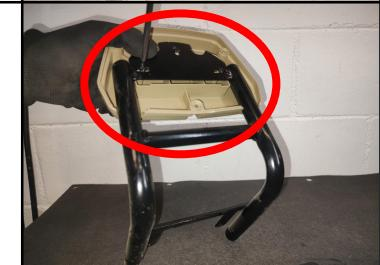
**Passo 3: Montar carenagem Nº 2 do encosto traseiro, (utilizar chave PHILIPS).**
