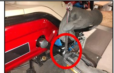
**Passo 7: Remover os parafusos de fixação das pedaleiras, (utilizar chave canhão Nº 10 e chave de boca Nº 10).**
