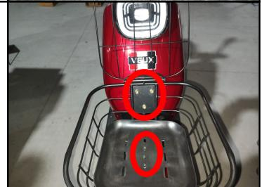
**Passo 29: Remover parafuso de fixação do banco traseiro, instalar o banco traseiro e reapertar o parafuso de fixação, (utilizar chave PHILIPS).**
