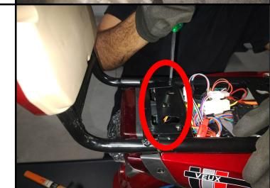
**Passo 5: Instalar o banco, (utilizar chave de boca Nº 13), Obs.: Caso necessário, ajuste a altura do canote, para uma pilotagem mais confortável.**
